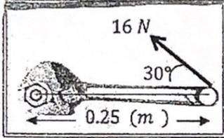
1- الشكل المجاور يوضح مقك طول ذراعه ( 0.25 ) m يستخدم لربط صامولة بتأثير قوة مقدارها ( 16 ) N تصنع زاوية ( 30° ) مع ذراع المفك، فيكون مقدار عزم تلك القوة بوحدة ( N.m ) يساوي :
