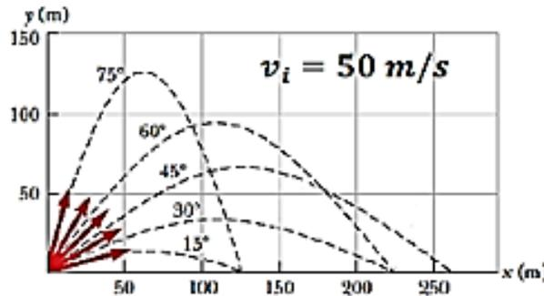
**مثال :** ماذا يحدث للمدى الأفقي لقذيفتين اطلقتا بالسرعة نفسها من نفس نقطة الإطلاق وبزاويتين ( $15^\circ$ ) و ( $75^\circ$ ) بالنسبة للمحور الفقي وبإهمال مقاومة الهواء ؟
